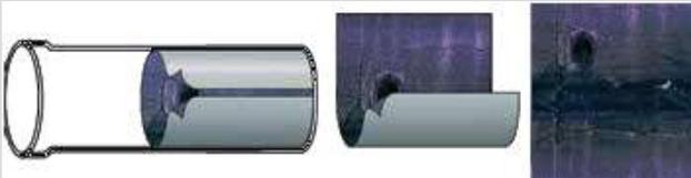
パイプの内側壁検査映像と、ソフトウェアの連携で計測、編集処理を容易にします。
